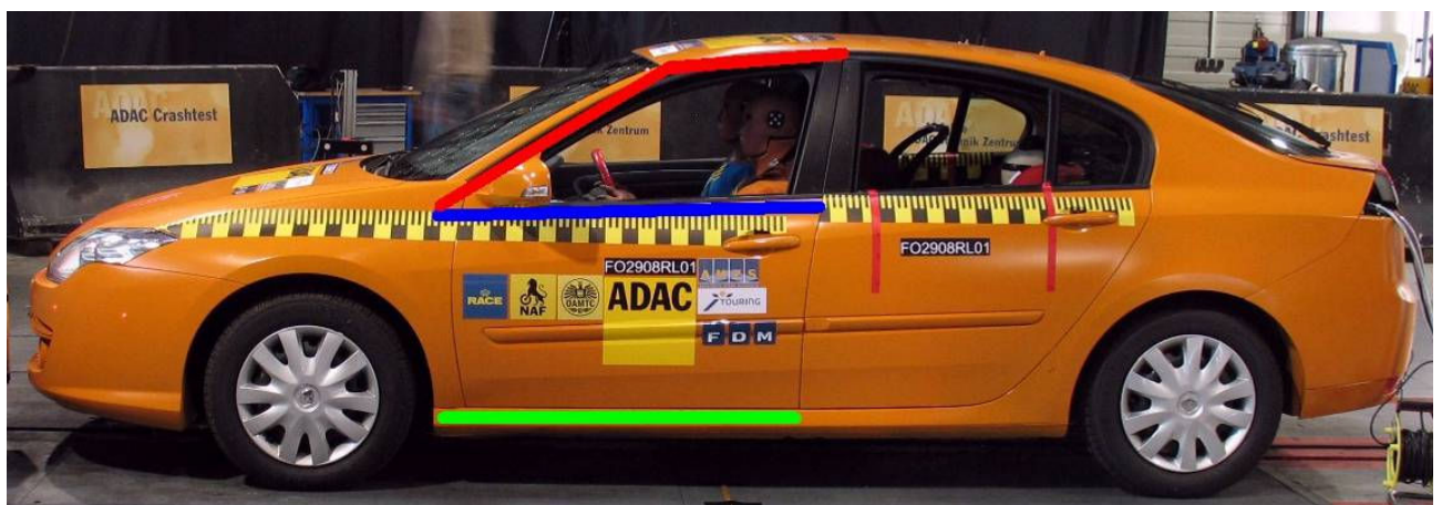
Figura 3: tres trayectorias de carga (representadas en rojo, azul y verde) conducen la energía del choque a lo largo de la cabina.
