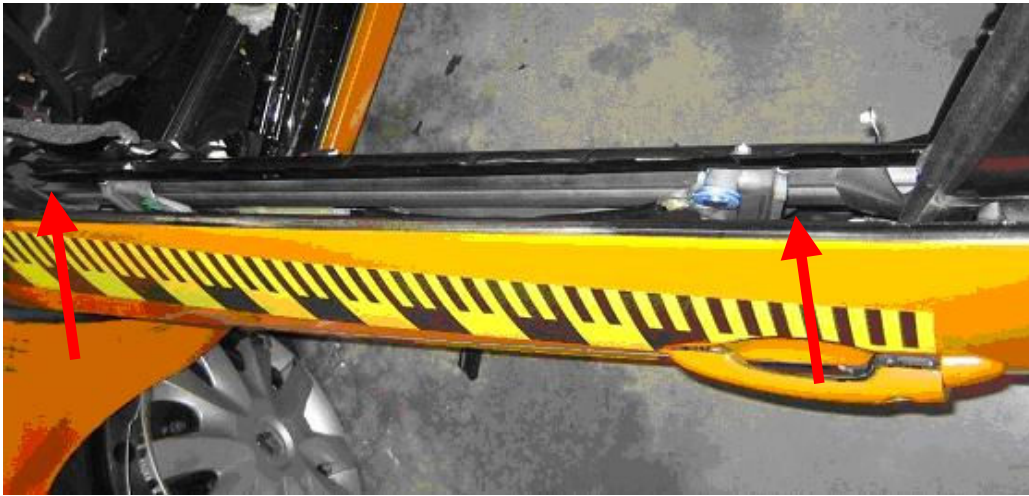
Figura 6: vigas metálicas en la puerta.
